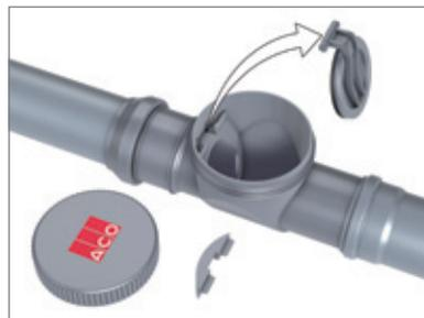
Keine Querschnittsverengung, dadurch ist die Reinigung der Rohrleitung in beide Richtungen optimal möglich.
