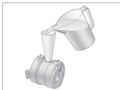
Die Funktionsprüfung der Rückstaeinheit wird im ausgebauten Zustand durchgeführt. Zur Prüfung Klarwasser in den Trichter füllen, bis 100 mm Wassersäule erreicht sind. Müssen innerhalb von 10 Minuten nicht mehr als 500 ml Klarwasser nachgefüllt werden, um die Wassersäule zu halten, gilt der Rückstauverschluss nach DIN EN 13564 als dicht.
